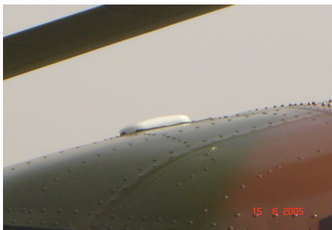
Obr. 2. Umiestnenie antény GPS prijímača Trimble 2101 na vrtuľníku Mi-17 Modern.
